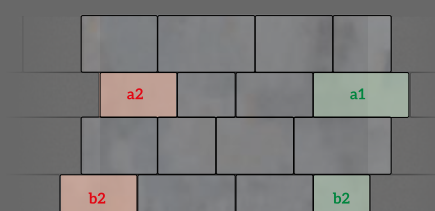
2) Versatz. Durch den einfachen Austausch einzelner Steine werden Kreuzfugen vermieden.
